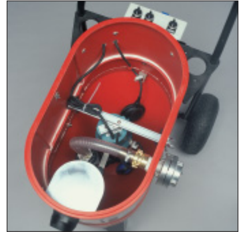
Innenansicht mit eingesetzter Pumpe und Schwimmerschalter für Saugmotor und Pumpe.
