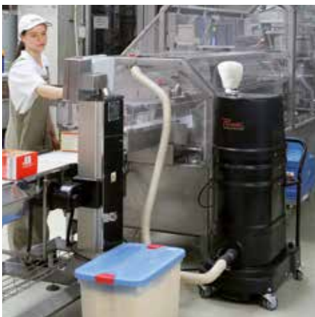
R01 R022 w wersji zabezpieczonej przed wybuchem pyłu w produkcji artykułów spożywczych
