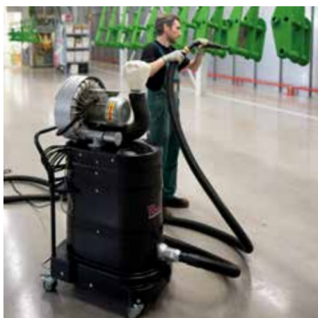
R01 S 022 w wersji zabezpieczonej przed wybuchem pyłu w technologii obróbki powierzchni (powłoka proszkowa)
